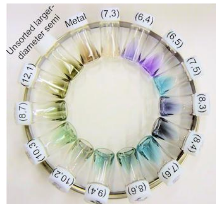
図9 分離された13種類の単一構造SWCNTと、金属型SWCNT、分離残渣の水溶液。個々に電子構造が異なるため、異なった色を示す。エレクトロクロミック素子への応用も可能。
