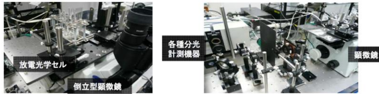
図20 倒立型顕微鏡に設置した放電光学セル(左)と構築した時間分解顕微分光システム(右)
