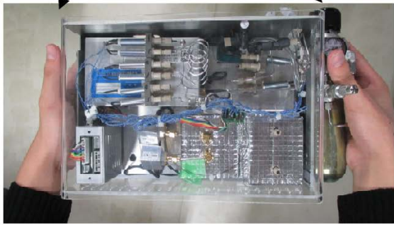
完成したボールSAWガスクロの 実証機(2011.9)
