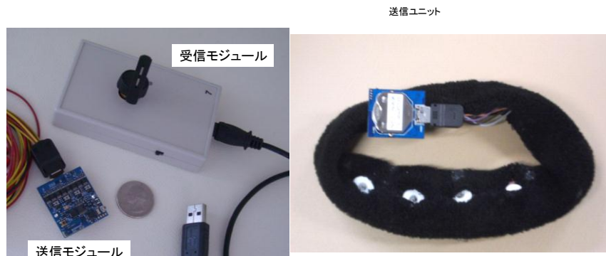
図 7 ギガヘルツ帯トランシーバ(2.4GHz)を用いたワイヤレス脳波センサー基板とそれを組み込んだヘアバンド型脳波センサー(プロトタイプ)
