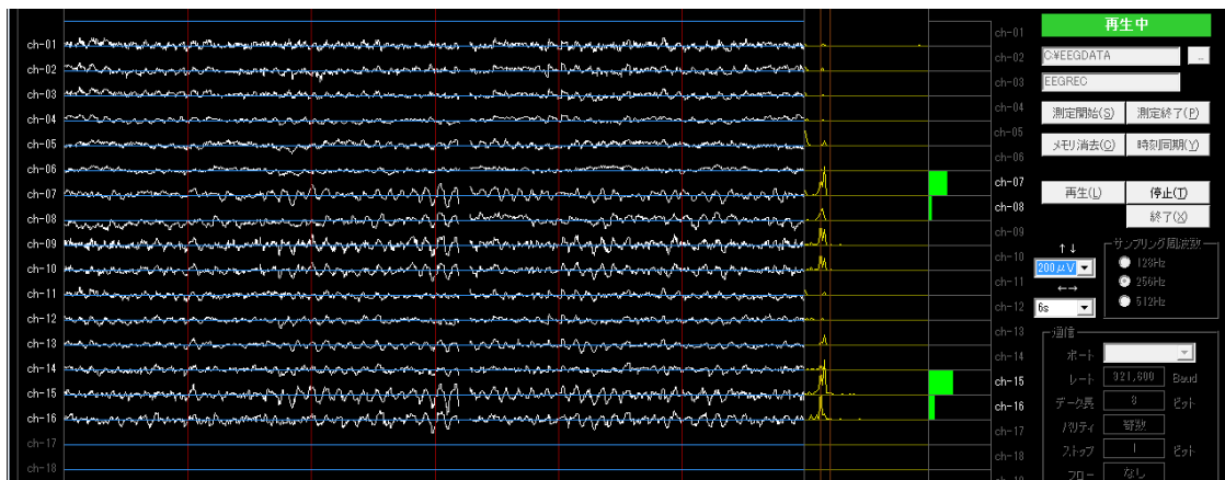
図 13 多チャンネル脳波センシングシステムにおける脳波解析の画面。脳波の時間波形および1秒毎のデータブロックを用いたスペクトルおよび FBA- index がすべてのチャンネルに組み込まれリアルタイムで表示されている。
