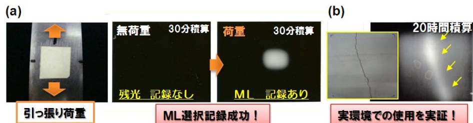
図 4.2.2 (a) 応力発光選択記録実験。積算記録時間：30 分、荷重：14 kN、(b) 選択記録処理をした応力履歴記録システムの実証試験。
