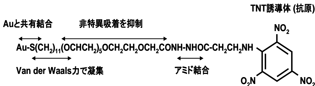
図5 TNT 誘導体固定化チオールの分子構造
