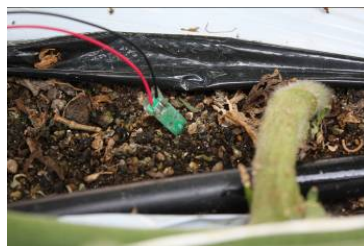
図 9.有線による土壌養分濃度・地温計測
