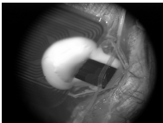
図 11 マイクロプローブセンサによるラットの末梢神経計測実験
