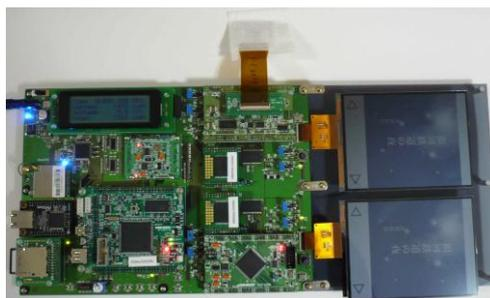
図 4.3.2 反射型白黒液晶ディスプレイをガラス基板上と FPGA で駆動した時の消費電力を比較するデモ機
