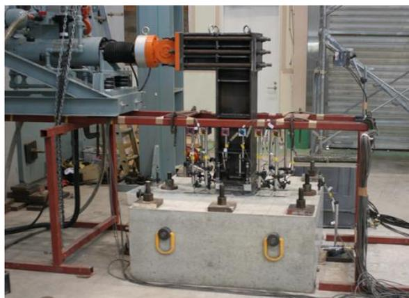
図 23. 建屋・機器接合部位の載荷実験。
