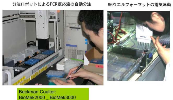
【図 26】 PCRスクリーニングの大量処理。大量のサンプルを効率よく処理するため、分注ロボット(左)と 96 ウェルフォーマットによる電気泳動システム(右)を導入している。
