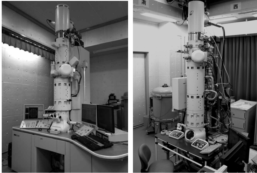
図 1-5 低加速電子顕微鏡試作機の外観。左:1号機(Cs補正 TEM/STEM)、右:2号機(Cs/Cc補正 TEM)。
