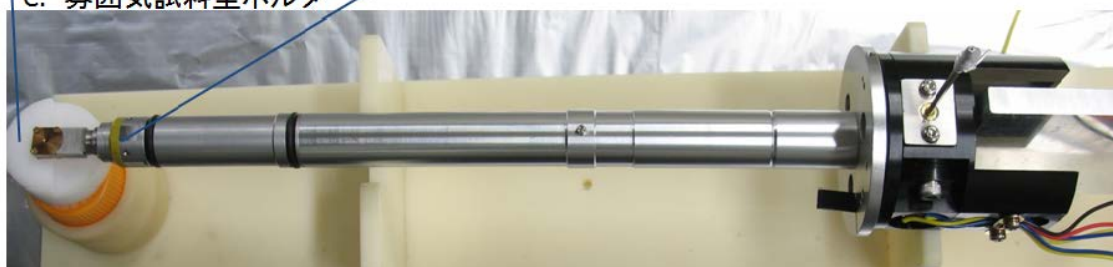
図 8 新規デザイン雰囲気試料室とホルダー
