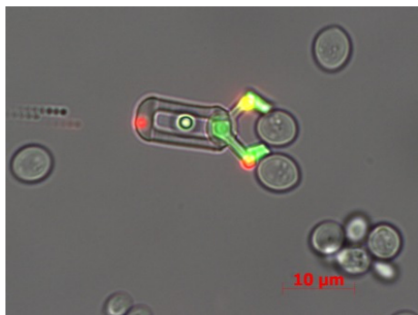
Fig. 4.1.4 本体は無蛍光樹脂、マーカー点は蛍光樹脂、細胞を掴む手の部分は接着性高分子の3種類の樹脂によって構成された光駆動ナノマシン
