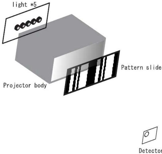
図 4.4.3.7 Single Track Gray Code Projector の基本原理
