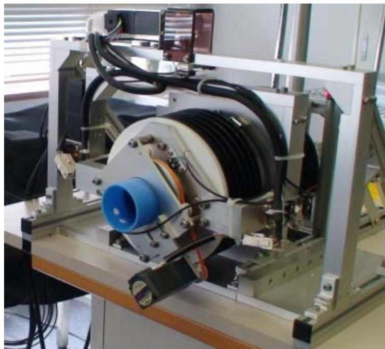
図4.4.1.1 射出方向制御高速化香りプロジェクタ
