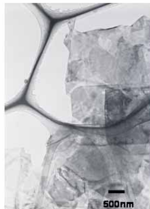
図24 剥離した酸化ニオブナノシート(TEM 像)
