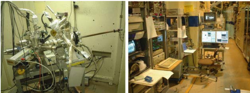
XANAM 装置(高エネルギー加速器研究機構、物質構造科学研究所、放射光研究施設) (左：X線防護ハッチ内部の装置、右：ハッチ外部の制御コンソール)
