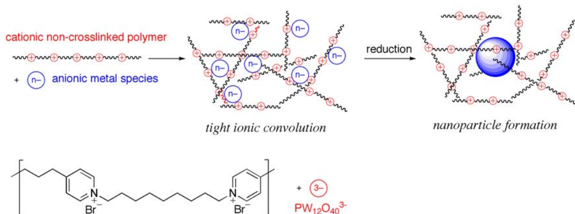
図10. イオン性架橋コンポリューションの概念とタングステン酸の実施例
