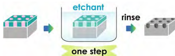
図 2c.1 PEO ナノシリンダーアレイをナノチャンネルとしたウェットエッチングプロセス。
