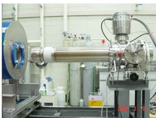
P5:KobeEBIS, 「脱着可能」超伝導磁石.
