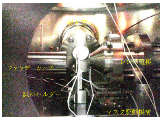
P6：(左)KobeEBIS とビームライン. (右)照射室内の様子.
