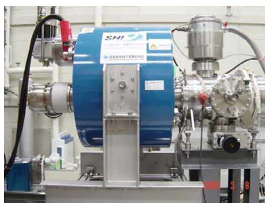
P5:KobeEBIS, 「脱着可能」超伝導磁石.
