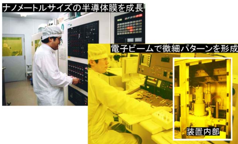
(極微構造研究の基本装置: (上)有機金属気相成長装置、(下)電子ビーム露光装置)
