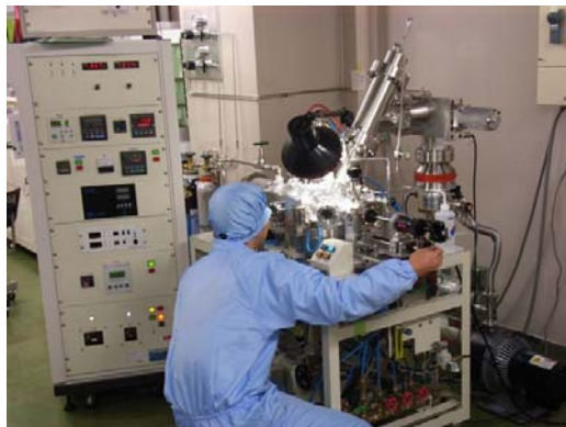
(光スイッチ研究グループ:超高真空下での異種基板直接貼り付け)
