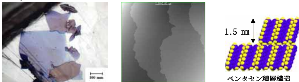
図 2 ペンタセン完全結晶の光学顕微鏡写真と NC-AFM 像および単分子ステップの分子構造模式図。
