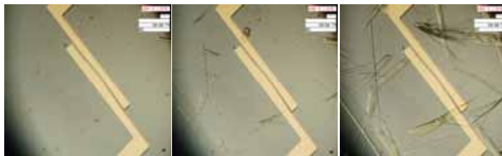
図 1 基板上での DT-TTF 結晶成長連続写真
