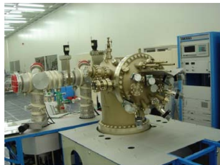
量子ドット作製装置 (MBE 装置) のクリーンルーム (北大電子科学研究所ナノテクノロジー研究センター) への導入風景 (H15 年 12 月 22 日、クリスマス前の 2 コマ)。
