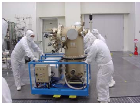
量子ドット作製装置 (MBE 装置) のクリーンルーム (北大電子科学研究所ナノテクノロジー研究センター) への導入風景 (H15 年 12 月 22 日、クリスマス前の 2 コマ)。
