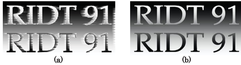
図 29 グラデーション画像(BMP, 24bits/pixel, 528x278, 430KB)を函数化した画像の比較 (a)従来法(単色領域函数化)[226KB]、(b)提案法(領域二変数函数化)[3.18KB] 従来法(a)ではアーティファクトが多数見られるのに対し、提案法(b)ではアーティファクトが発生することも無く、さらに圧縮率の面でも大幅に改善されている。
