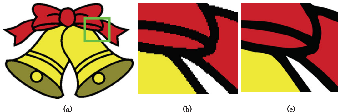
図28 イラスト画像を函数化し、縦横それぞれ5倍に拡大した画像の比較 (a)入力画像[BMP, 8bits/pixel, 472x363, 168KB]、(b)従来法[JPG, 487KB]、(c)提案法(輪郭函数化)[3KB] 従来法(b)ではアーティファクトが多数見られるのに対し、提案法(c)ではアーティファクトが発生することも無く、さらに圧縮率の面でも大幅に改善されている。
