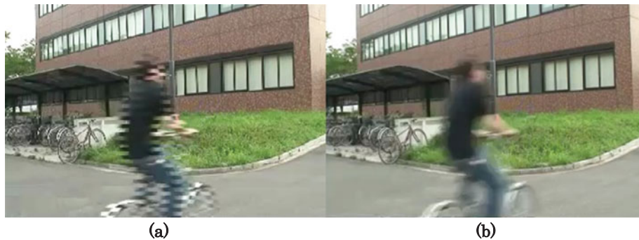
図 38 HD(1920x1035)サイズの映像を(a)単純間引き法と(b)フルエンシ法でそれぞれ QVGA(320x240)に縮小した結果の比較 従来法(a)ではインタレースの影響によって移動する人物の輪郭に多数のジャギーが現れるのに対し、フルエンシ方式(b)ではノイズの少ない高精細な映像が得られている。
