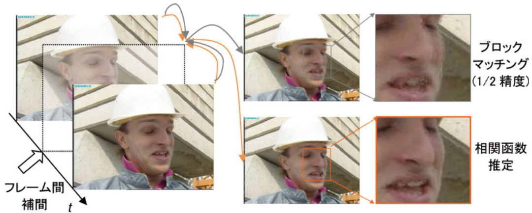
図 53 高フレームレート化による映像の高品質化 従来手法(1/2 のブロックマッチング)で推定された動きに基づいて生成された中間フレームがぼやけているのに対し、提案手法(フルエンシ関数に基づく相関関数の推定)で推定された動きに基づいて生成された中間フレームは画像が鮮明である。
