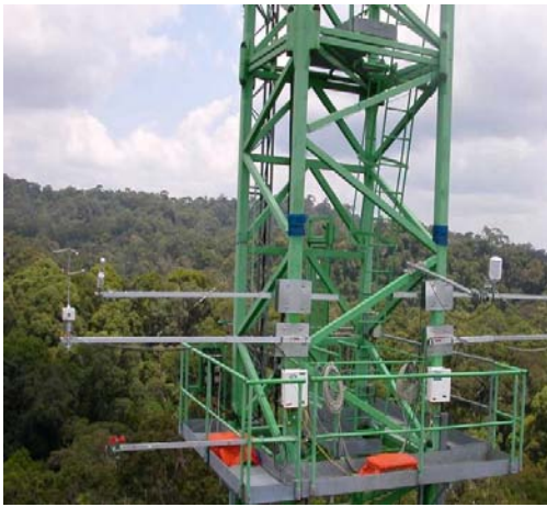
写真1 サラワク・ランビル国立公園の林冠クレーン 左：フラックス測定状況、右：全景
