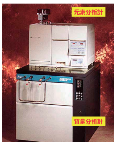
元素分析計直結型質量分析計 植物体内の窒素化合物の窒素をデューマ法により、窒素ガス(N 2 )に変換し、装置の裏側にある細管を通して質量分析計の検出器部分に直接導入し、窒素の同位体組成、量を調査する。未解明窒素は本装置を使った実験がきっかけでその存在が予見された。
