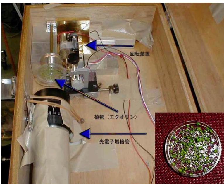
図9 重力方向変化に伴う細胞内 \text{Ca}^{2+} 濃度変化のモニター装置
