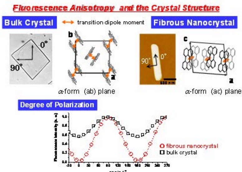
図 8 板状バルク結晶およびファイバーナノ結晶の外形と蛍光偏光異方性解析結果
