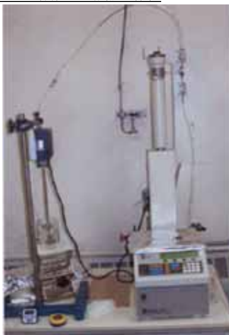
図5 無脈流シリンジポンプを用いた再沈法の装置図
