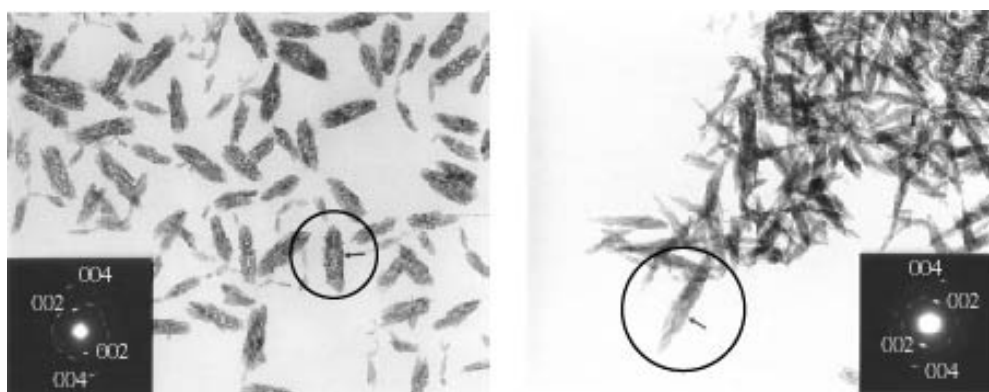
図 3 アパタイト/多糖類複合体の透過型電子顕微鏡像
