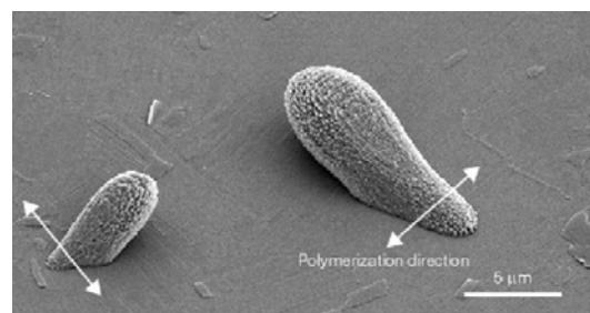
図 3. 表面にカルボキシル基が規則的に配列した重合化膜上に形成された Mg 含有炭酸カルシウムの結晶. 膜の重合化方向に従って結晶の方向が制御されている.
