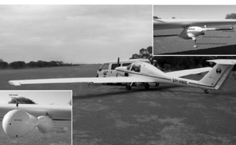
図 3-3-9 フラックス測定用小型飛行機
