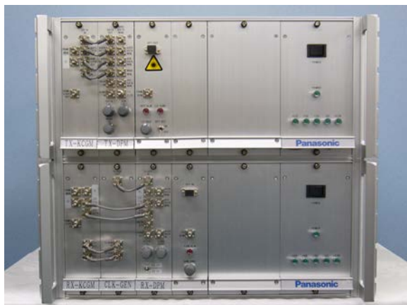
図3 松下電器による 1 Gbps Y-00量子暗号通信装置・外観
