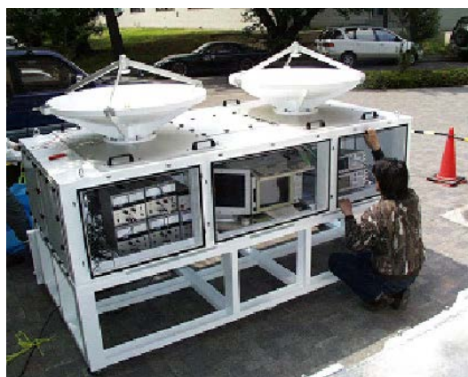
図 4.4.6 : 既開発の 95GHz ミリ波 FM-CW レーダの外観
