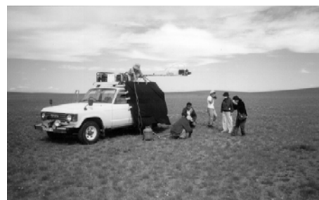
図3 車両による移動多点観測
