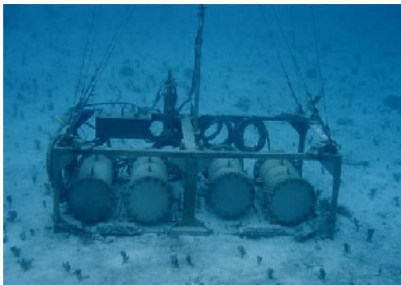
写真2 水没型 CO<sub>2</sub> 計測システム。パラオ諸島サンゴ礁において、1999年11月から2000年11月まで1年間の通年観測を行なった。測定機本体は左端のもので、他の3つは電池ボックス。電源は市販の電池を1419個収納した。消費電力は15W。
